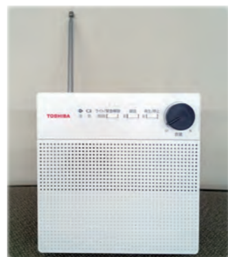
防災行政無線戸別受信機(写真上) と中継局(写真下)
