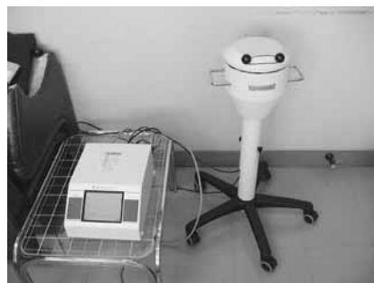
給食センターに配備された放射能測定器
