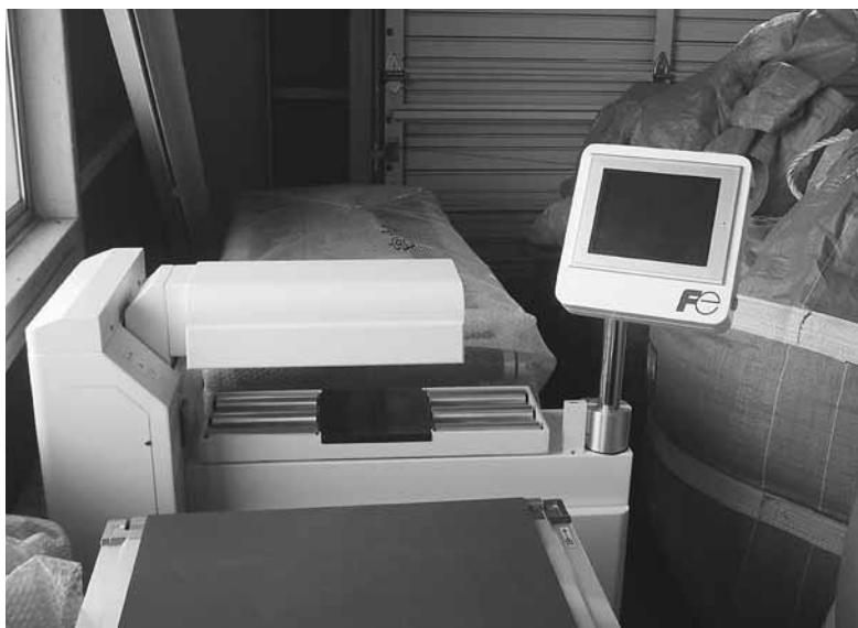
瞬時に判定できる放射能測定器
