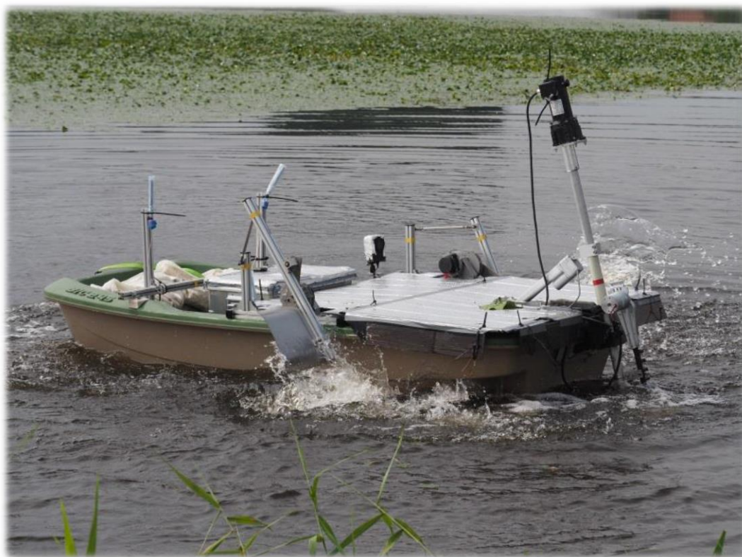
伊豆沼でのハス刈りボートによる刈取り作業の様子
