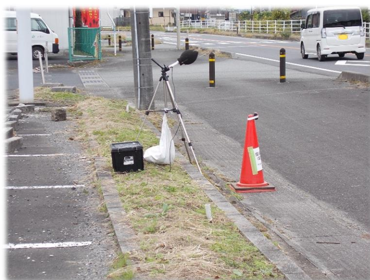
自動車騒音測定の様子（築館地区）
