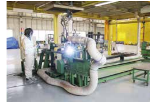
▲溶接ロボットを操作している様子
