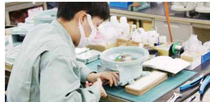
▲風向風速指示器の組立の様子
