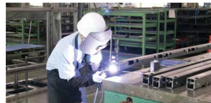
▲フレームを溶接する様子
