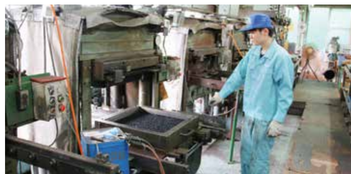
▲ならしたゴムチップをプレス機で成型する様子
