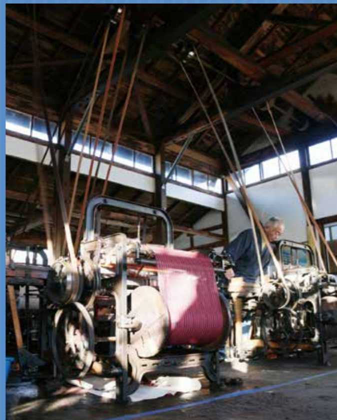
▲建物入口にあるモーター1台の動力を、天井から吊るしたベルトで伝えて作業場内の全ての機械を駆動
