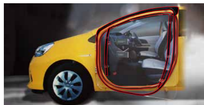
▲車両のボディ・ドアに装着されるウエザストリップ(赤枠部分)
