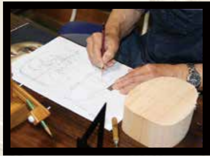
①材料は檜を使用します。型紙で輪郭を写します。輪郭を決めて、面裏に基準の線を引きます。
