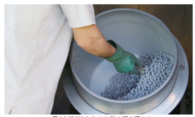
▲星（火薬玉）を丸め火薬の層を重ねる
