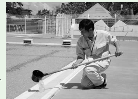
▲定期的にプールの水を採取し、測定します
