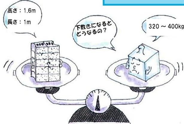
高さ1.6m、長さ1mのブロック塀の重さは、320～400kgです。たとえば、その破片であっても、私たちの力で支えられるものではありません。倒壊などにより、高いところから直撃を受けると、重大な事態が生じます。
