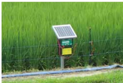
被害防止のために設置した電気柵
