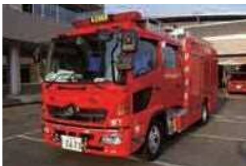
整備した水槽付消防ポンプ自動車
