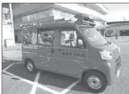
小型動力ポンプ付軽四輪駆動積載車 (デッキバンタイプ)
