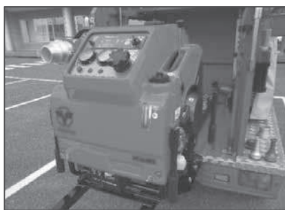
小型動力ポンプ
