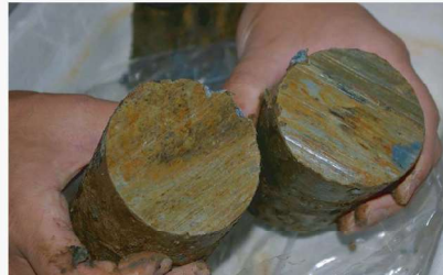
すべり面粘土
