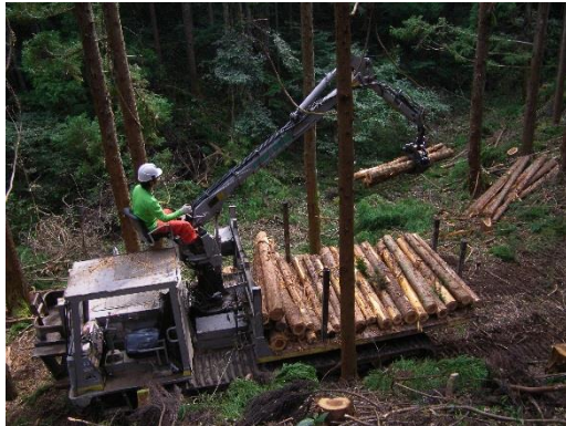
(フォワーダによる集材作業)
