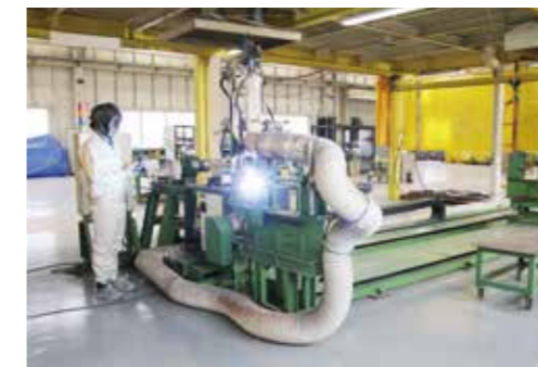
▲溶接ロボットを操作している様子
