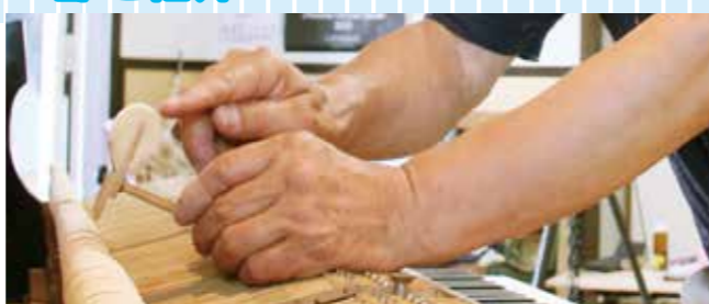
②ハンマーの先端を調整(整音) 弦を打ち続けることで摩耗したハンマー先端のフェルト面を、削るなどで調整し、音や響きのバランスを整えます。
