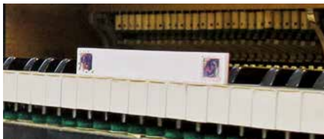
③鍵盤の高さ・押したときの深さを調整(整調) 定規を使って鍵盤が水平を保っているか確認し、鍵盤の下に調整用の紙を入れて高さを調整します。
