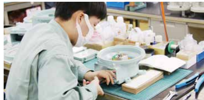
▲風向風速指示器の組立の様子
