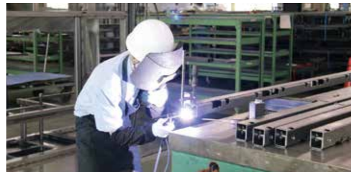
▲フレームを溶接する様子
