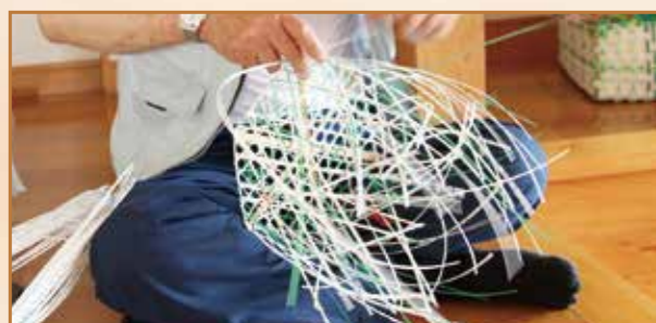
④ 底の形が崩れないように、竹板などで補強し、側面を編んでいく。
