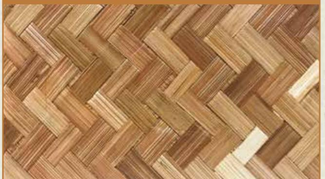
縦横どちらも同じ幅のひごを使って、交差する部分を2本飛ばし、3本飛ばしにしながら隙間なく編んでいきます。
