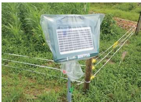
被害防止のために設置した電気柵
