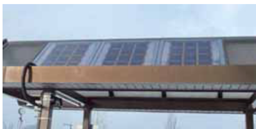
有機薄膜太陽電池の実証実験
