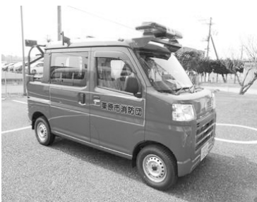
小型動力ポンプ付軽四輪駆動積載車 (デッキバンタイプ)
